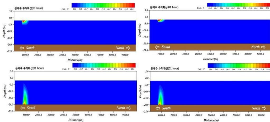
Figure 3. Longitudinal plume evolution : ambient vertical diffusion
